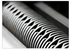
Schneidwellen aus gehärtetem Vollstahl
